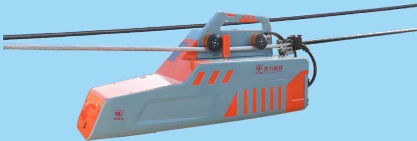
智能涂覆机器人主要应用于 10kV/35kV 裸导线的带电绝缘涂覆项目。随着我国城市化的不断推进，越来越多的老旧高压裸导线深入到居民的生活空间,因此，造成了极大的触电安全隐患，为了有效杜绝居民区触电事故的发生，国家电网、南方电网大力推行高压裸导线的绝缘工程。
